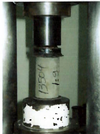
Figura 11 – Corpo-de-prova em compressão
