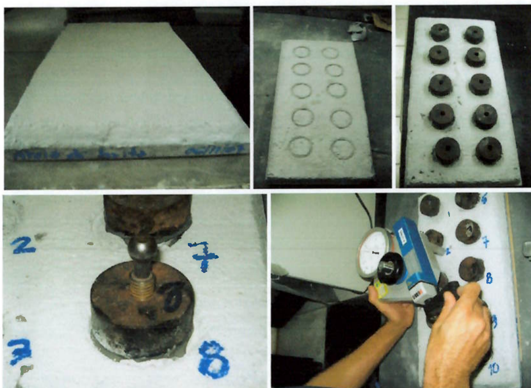
Figura 15 – Sequência do preparo das pastilhas até o ensaio potencial de aderência
