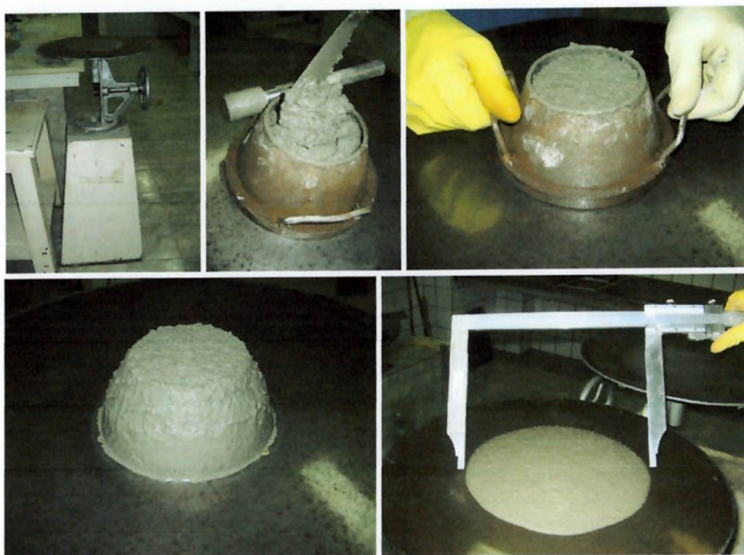
Figura 6 – Mesa de índice de consistência e argamassa sendo ensaiada
