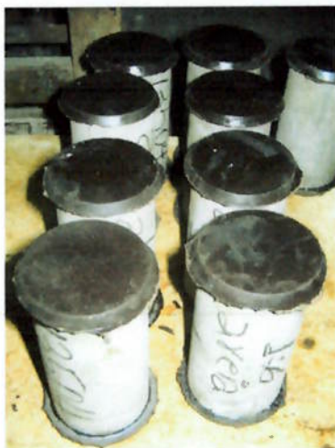
Figura 8 – Corpos-de-prova cilíndricos capeados
