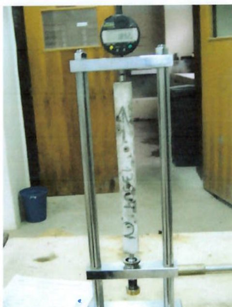
Figura 17 – Medidor digital da expansão de barras de argamassa
