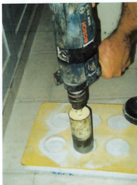
Figura 14 – Corte da argamassa com auxílio do gabarito
